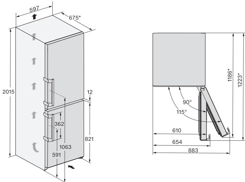
\* Mål uten monterte avstandsholdere. Dersom de vedlagte veggavstandsholderne monteres, økes produktdybden med 15 mm.
